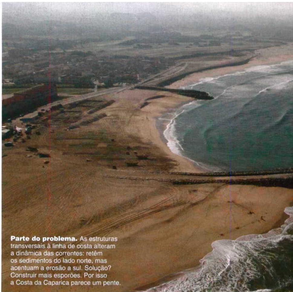
**Parte do problema.** As estruturas transversais à linha de costa alteram a dinâmica das correntes: retêm os sedimentos do lado norte, mas acentuam a erosão a sul. Solução? Construir mais esporões. Por isso a Costa da Caparica parece um pente.
