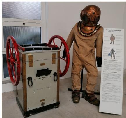
O escafandro é um equipamento de mergulho impermeável, fechado hermeticamente e, geralmente, feito de borracha e bronze. Criado em 1837, foi amplamente utilizado até cerca de 1940, sendo progressivamente substituído por equipamento de mergulho autónomo.
